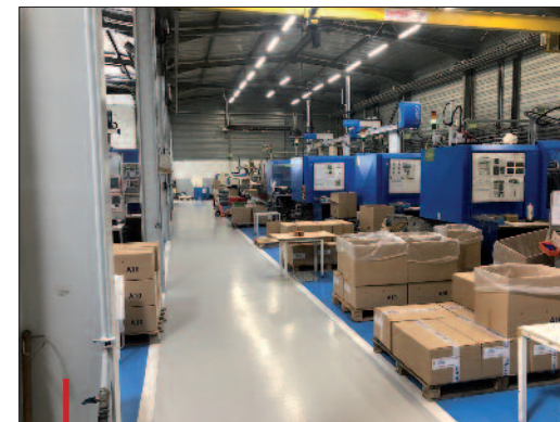
BG Plastic est équipé d'une série de presses Sumitomo-Demag tout-électrique de la gamme IntElect.
